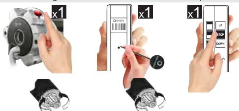
1. Taste am Motorkopf kurz betätigen
