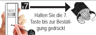
1. Drücken Sie 7 x die rückseitige P3-Taste, in kurzen Abständen, Halten Sie die 7. Taste bis zur Bestätigung gedrückt (± 4 Sek.)
