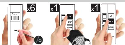
1. Drücken Sie 6 x die rückseitige P3-Taste des zu löschenen Senders
