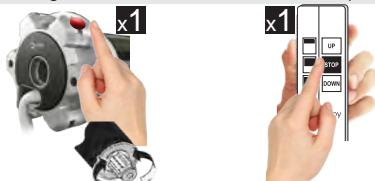
1. Taste am Motorkopf für 4 Sekunden betätigen
